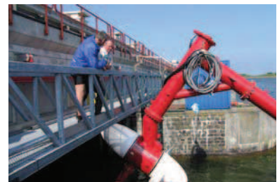
voorbeeld van een proefopstelling voor groene energie: Torcado T50 2800 proefopstelling bij de Afsluitdijk, ook voorstelbaar in het snelstromende Marsdiep
